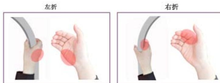
図 4.1 手すりを伝う際に手のひらに加わる圧力分布
