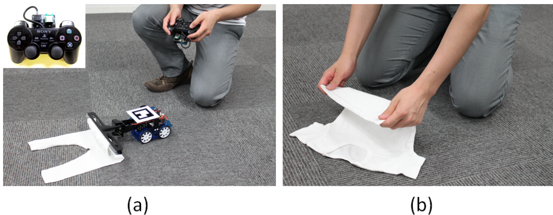
図 18 各条件の指示方法 (コントローラを用いた条件(a), 実際の服を手でたたみ指示を行なう条件(b))
