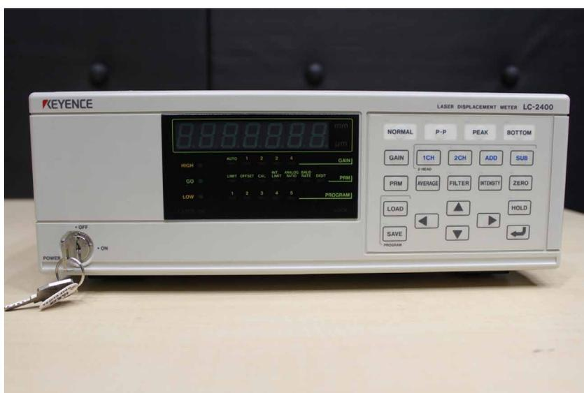
図4.1 レーザー変位計 LC-2400 (KEYENCE)
