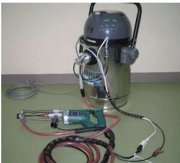
写真 5.3.1 冷却水吸引供給機 (上)、湿式二軸低騒音ドリル T-2 (下)
