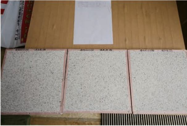
写真 5.3.51 擬石塗り見本 コーニスには右（白セメント：消石灰＝10：0）を採用した
