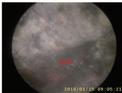
No.3 外壁表面から約 10 mm (1 層目) 境界面の空隙に充填されたエポキシ樹脂
