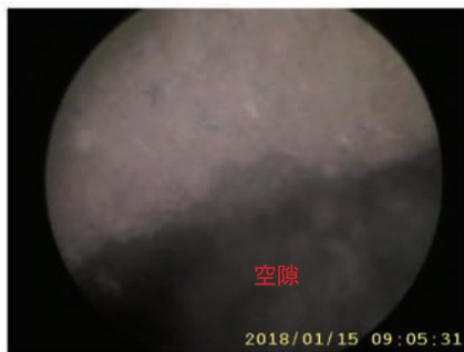
No.3 外壁表面から約 33 mm (2 層目) 境界面の空隙に充填されたエポキシ樹脂
