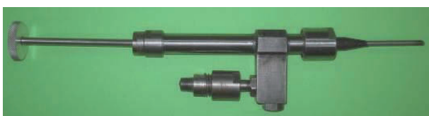
写真 5.3.3 多層空隙注入ノズル (FS ノズル)
