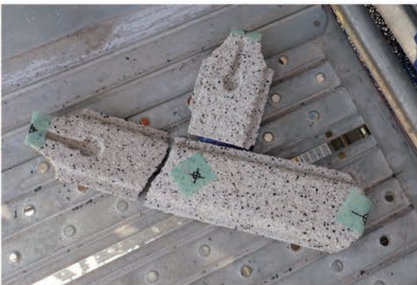
写真 5.3.33 過去の補修によるペンマーク (表)
