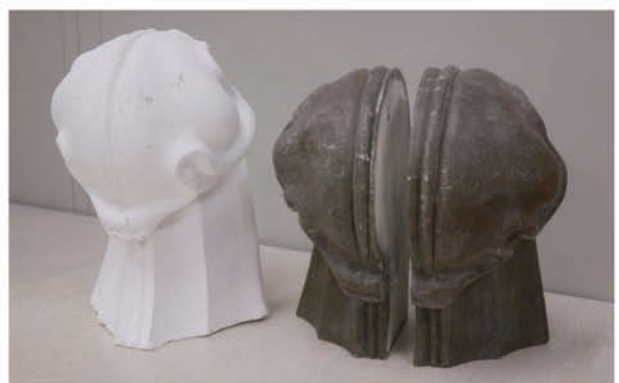
写真 5.2.15 石膏原型(左)、板金用雄型(右)
