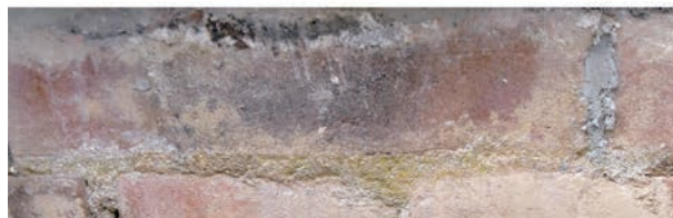
写真 4.3.14 焼成時の積み痕
