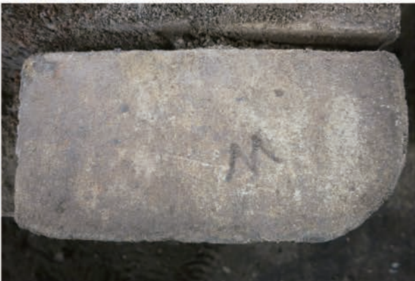
写真 4.9.6 煙道 耐火煉瓦(役物)
