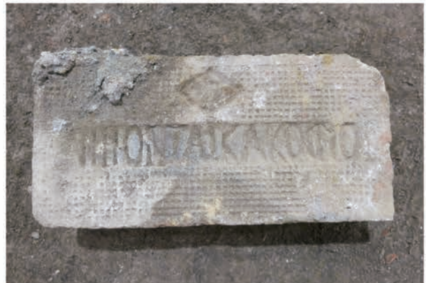
写真 4.9.10 煙道と煙突の接合部には日本耐火工業製耐火煉瓦が用いられていた
