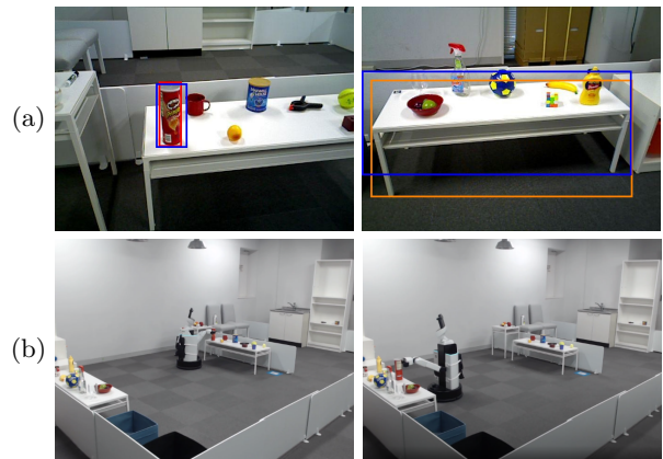
図 1 実機における定性的結果。(a) 対象物体候補および配置目標候補。(b) 把持および配置動作。指示文：“Put the red chips can on the white table with the soccer ball on it.”
