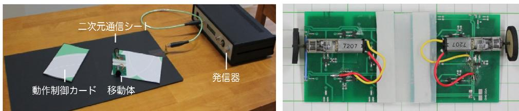
図1 二次元通信システムとカードで移動体を制御(左)，アンテナを複数備えた移動体(右)
