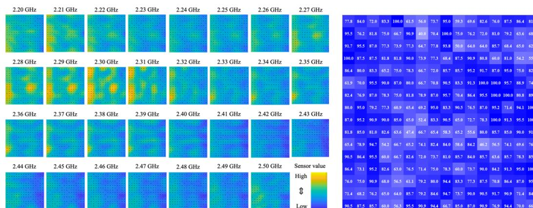
図 4 各周波数におけるシート上の電界強度分布 (左), 隣接点間距離 12mm のときの各位置における識別率 (右)
