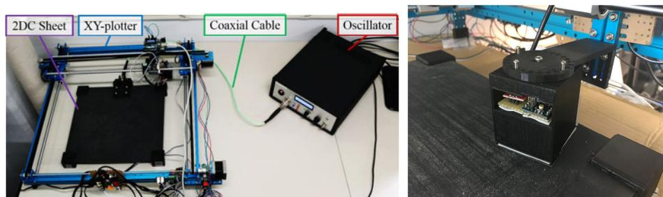
図 3 電界マップ構築システムの概要 (左), アンテナと回転可能な機構 (右)
