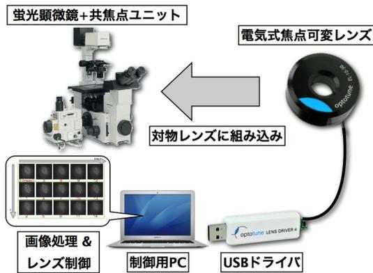
図2: 三次元1分子測定システム構成図
