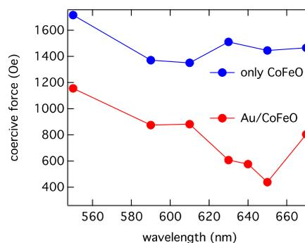
図 4 . ファラデー効果の磁場依存性から求めた Au 粒子を含む Co フェライトと Co フェライト単体の保磁力の波長依存性。
