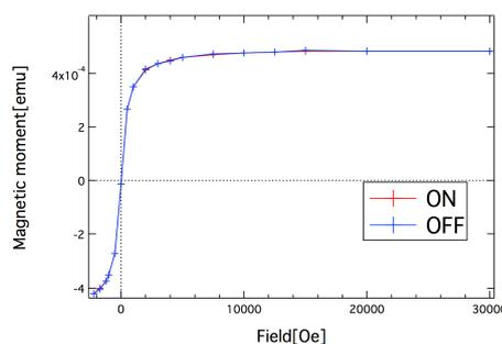
図 7 . レーザー照射下で測定した Au ナノ粒子/マグネタイトナノ粒子混合試料の磁化の磁場依存性。
