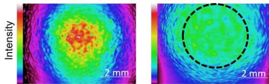
図 3 レーザの強度プロファイルの調整
