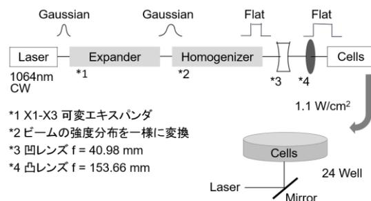
図1 近赤外レーザー照射系の概要
