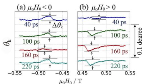
図3 μ-MOKE 計測システムにより測定した Co/Ni 多層膜の FMR スペクトル
