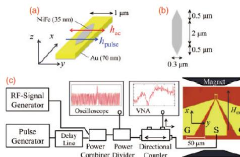
図2 CS 法の実験セットアップ図
