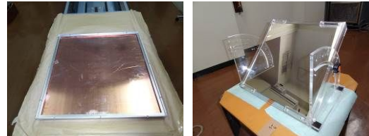
図2 製作した面積型検出器と反射鏡
