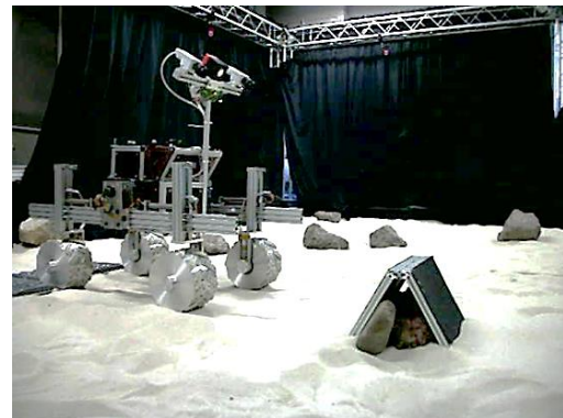
図 8: 障害物乗り越え実験の一例
