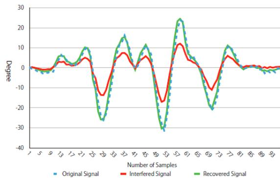
図 3 リーダ側での干渉除去により同時に応答する RF タグの信号を分離
