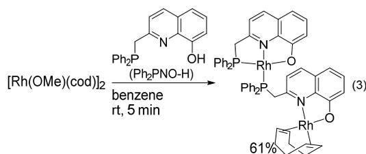
この錯体は様々な配位子と反応し、[(2-Ph<sub>2</sub>PCH<sub>2</sub>-Q)(L)Rh] 錯体 (L = PPh<sub>3</sub>, P(4-MeOC<sub>6</sub>H<sub>4</sub>)<sub>3</sub>, P(4-CF<sub>3</sub>C<sub>6</sub>H<sub>4</sub>)<sub>3</sub>, C<sub>5</sub>H<sub>5</sub>N) へと効率的に変換することが可能であった(式4)。また、合成した錯体の構造は単結晶 X 線回折により確認した。
