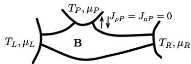
図3：時間反転対称性の破れが熱電効果にどう影響するかを議論するために用いた擬2端子系。3端子目は、散逸源としての役目を持つ。
