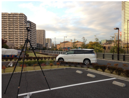
図12 LiDARによる車両認識・制御の様子
