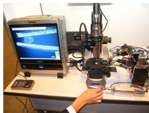
図1 開発に成功したマイクロハプティクスによる砂糖一粒の把持動作
