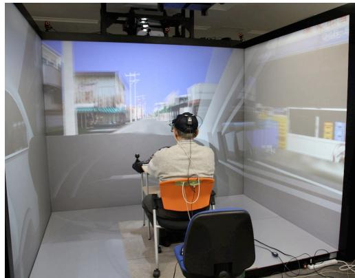
図 3:没入ドライビングシミュレータによる高齢ドライバの運転行動観察実験の様子
