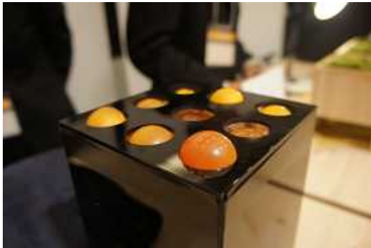
図 5: 風船膜アレイを用いた 実体ディスプレイ
