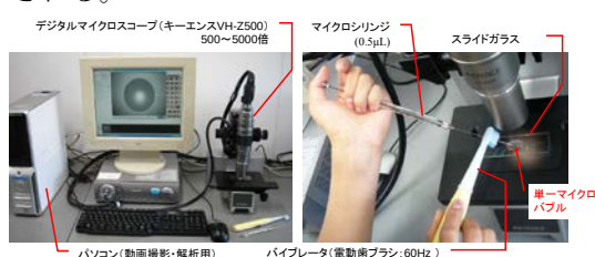
図 1. マイクロバブルの収縮・晶析実験
