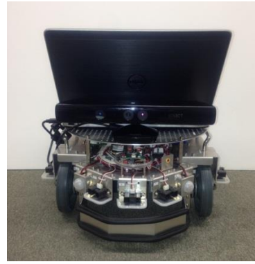
図3 KINECT 他多数のセンサを設置したセンサエージェントロボット
