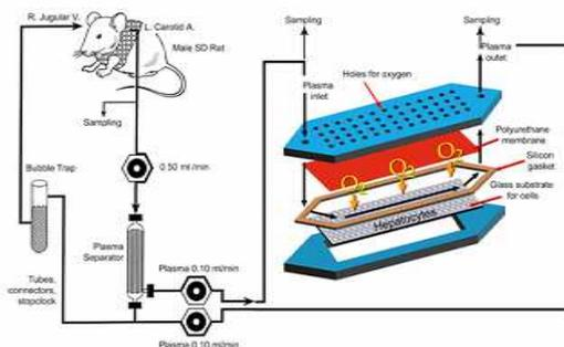
図3：HMGB-1 A Box 産生性肝細胞の体外循環型リアクターへの植え込み
