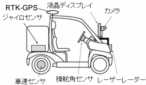
図1 視覚情報の影響評価のための実験車両
