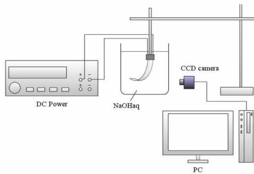
図1 変形特性評価システム
