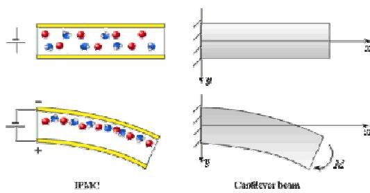
図6 IPMC アクチュエータの簡易はりモデル
