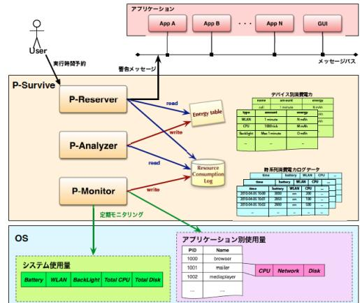
図 6 消費電力量予約機構の概要
