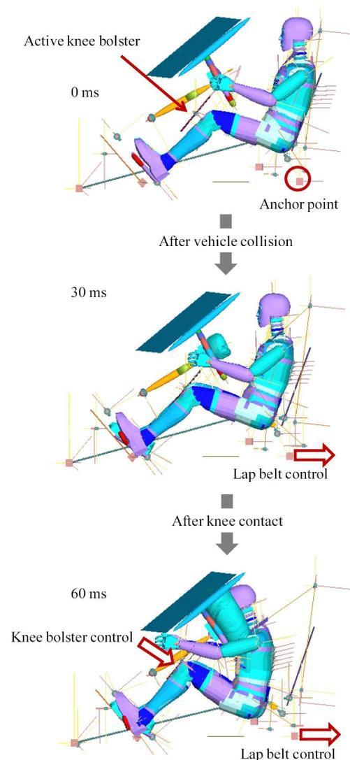
図1 乗員保護制御システムの動作（3次元モデルによるシミュレーション）
