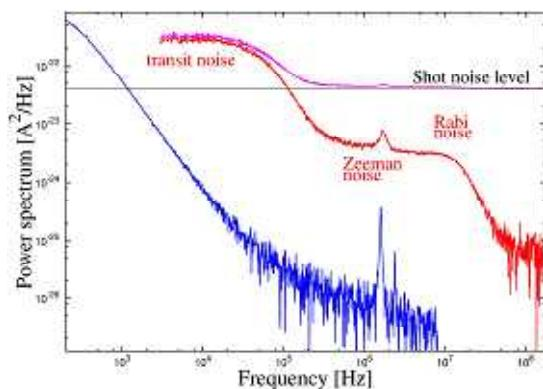
図 2：ルビディウム原子の光吸収の揺らぎスペクトル。従来の測定法では散射雑音(shot noise)のため, グラフ中の黒い線より上しか測定できなかった。スペクトルには, 原子がレーザービームを横切るための雑音(transit noise), 磁場中の原子が歳差運動をすることによる雑音(Zeeman noise)と量子的準位間を共鳴遷移するための雑音(Rabi noise)の寄与がはっきりと観測されている(赤)。バッファガスにより雑音を抑えた場合(青)も対比させるために表示している。
