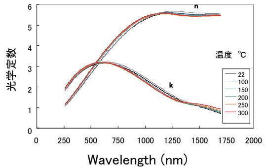
図 1：結晶  $\text{Ge}_1\text{Sb}_2\text{Te}_4$  の複素屈折率
