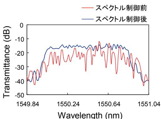
図 8 : スペクトル制御回路の透過特性
