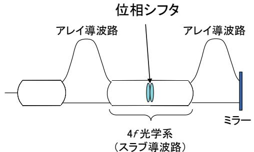
図5：2段型分散補償器の構成
