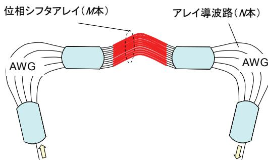
図 7 : スペクトル制御回路
