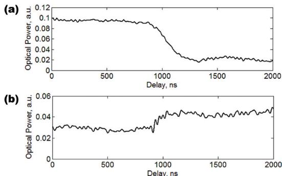
図4：(a) アモルファス化応答波形、
