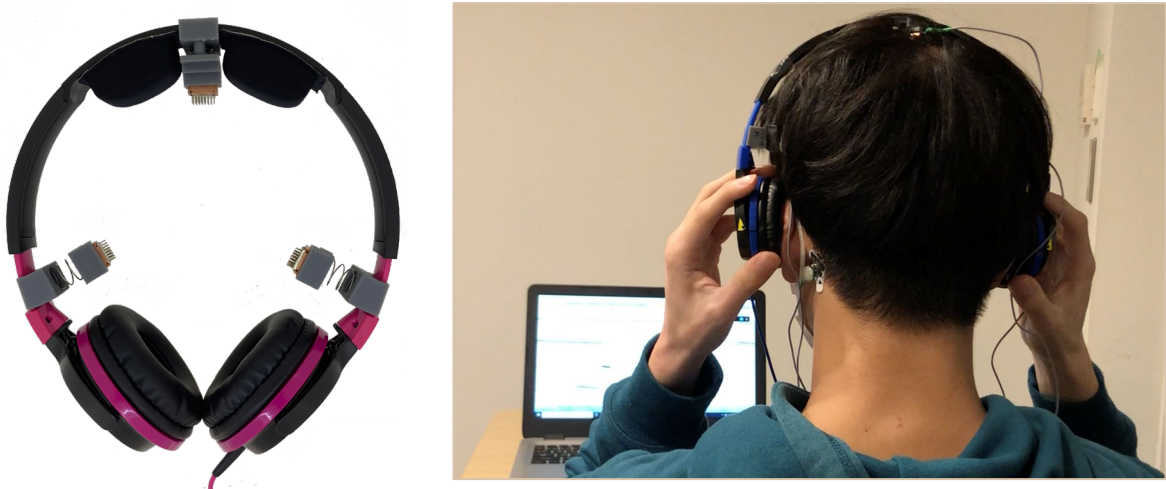
図2. 30秒で取り付け可能で、2時間の継続的脳波計測が可能な脳波計測ヘッドセット
