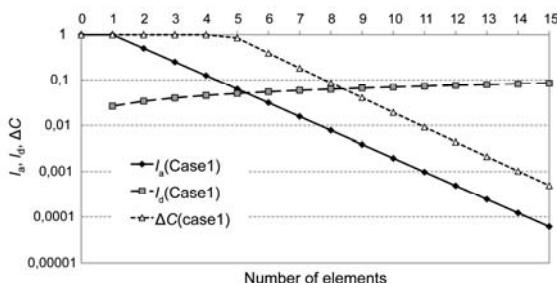
図 6 Kenics スタティックミキサーにおける混合度
