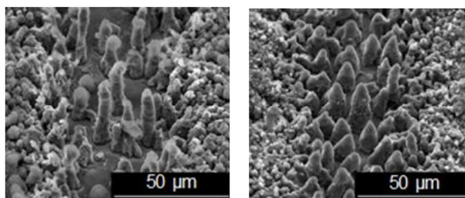
(a) 走査速度  $1 \text{ mm/s}$  (b) 走査速度  $10 \text{ mm/s}$
