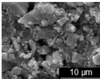
図 2 レーザ照射前の混合粉末の SEM 画像
