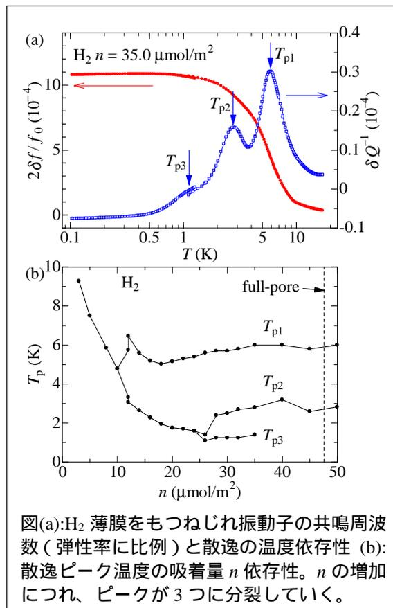
図(a):  $H_2$  薄膜をもつねじれ振動子の共鳴周波数(弾性率に比例)と散逸の温度依存性 (b): 散逸ピーク温度の吸着量  $n$  依存性。  $n$  の増加につれ、ピークが3つに分裂していく。
