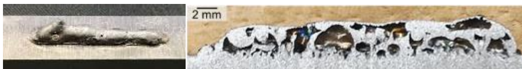
図1 左：造形物外観 右：造形物断面（空孔率 49%）
