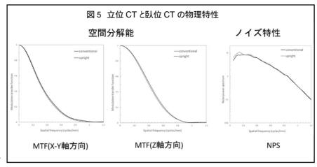
同期して上下することで水平性を保つことになっているが、少しでも左右の上下運動にズレが生じると画像が歪むことになる。通常の臥位 CT は、ガントリーは頭尾方向には動かず、患者の乗った台が頭尾方向に動くので、画質に歪みが生じない。性能評価の結果、立位 CT の空間分解能、ノイズ特性、CT 値の物理特性が臥位 CT と全く同等であったということは、ガントリーが正確に上下運動を出来ているということである。
