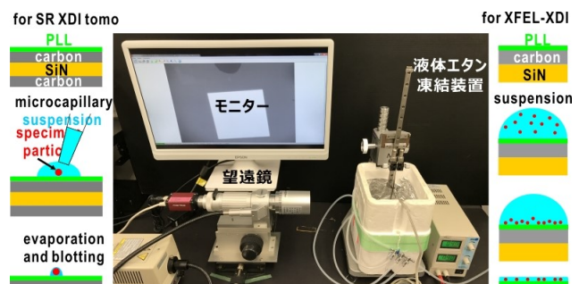
図2 水和凍結試料作成手順 (両脇) と導入した長動作距離望遠鏡による凍結試料観察 (中)。
