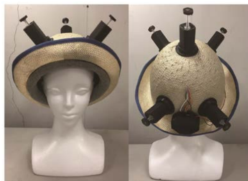
図5. 脳波電極固定機構。電極と頭皮の間隔を変更することができる。
