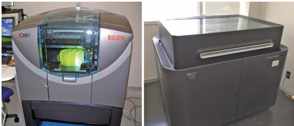
図1. 筆者が使用してきた3次元プリンター。左：EDEN 260，右：Connex 350。
