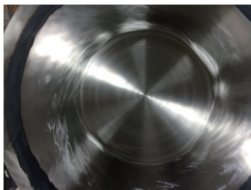
図3. 回転流の自由表面 水深1 cm, 回転速度3.0 rps。
