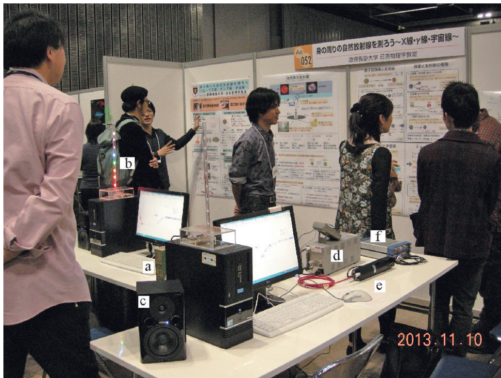
図4. 2台のガンマ線スペクトロメータはT字形に配置したテーブルの上に設置した。(a) 低ナトリウム塩, (b) LED, (c) スピーカー, (d) 高圧電源, (e) シンチレーターと光電子増倍管, (f) USB オシロスコープ。
