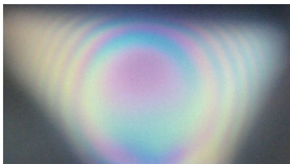
図 6. 水晶ポイント ( \perp c 底面) の先端の斜面から光を入れたエアリースパイラルの観察。水晶は図 3 (a) に用いたものと同じで ( 2 \times 2 \times 3 cm)，プリズムの配置などは図 5 (b) に示すとおりである。
