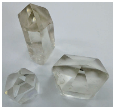
図1. 水晶ポイント。底面は六角柱に対して垂直にカットされている。サイズは左下の水晶から時計回りで、約 3 \times 3 \times 4 cm, 3 \times 4 \times 9 cm, 4 \times 6 \times 5 cm。
