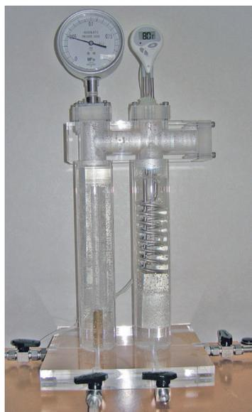
図9 内部加熱方式の蒸留器。加熱は、試作品なので電気ヒーターを用いている。左が凝縮部、右が蒸発部。ヒーターにより加熱すると、圧力に応じた沸点で沸騰を開始する。
