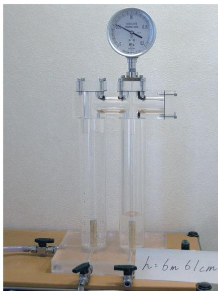
図8 本論文で述べた原理により減圧を行った実験装置。減圧に伴い水道水に含まれる気体が出て、泡となる。排水管の高低差が  $6\text{ m}61\text{ cm}$  なので、 $0.34$ 気圧まで減圧が可能であるが、水道水に溶け込んでいた気体の量が多かったので、 $0.54$ 気圧までの減圧であった。脱気した水を用いるか、排気管の高低差を大きくすればさらに減圧が可能である。
