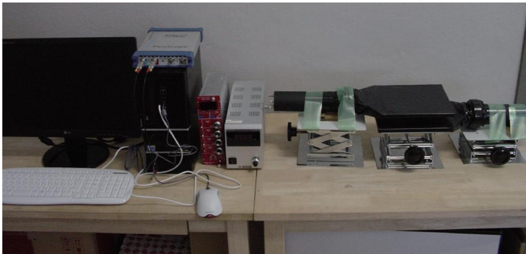
図8. 測定装置。左からディスプレイ、パソコン本体とps5203、高圧電源2台、シンチレータ2個。
