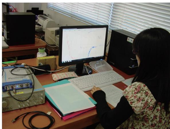
図11. 実習の様子。放射線計測実習としては比較的高度な測定を行っているが、従来の放射線計測（図1）と異なり安全で配線も測定も容易である。PicoScope ps5203の下にあるのは発振器で、同軸ケーブル中を伝搬する電気パルスの伝搬速度を測定する際に用いる。
