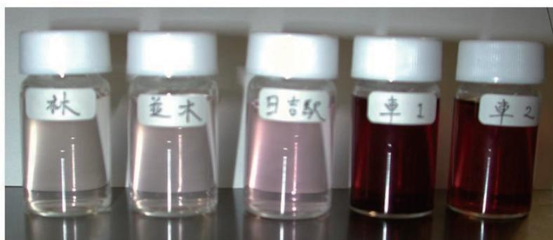
図5 測定場所の大気と自動車の排気ガスによるザルツマン試薬の発色の写真(右)
