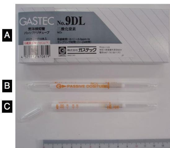
図2 ドジチューブ。A:ケース (10本入り), B:未使用の状態, C:使用時。先端を折り取って放置すると内部に青いバンドが生じ、そのバンドがどこまで出来ているか目盛りを読み取ることで濃度を測定する。
