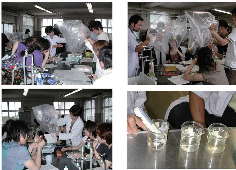
図4 実習風景（ザルツマン試薬の反応）とたまり水のpH測定
