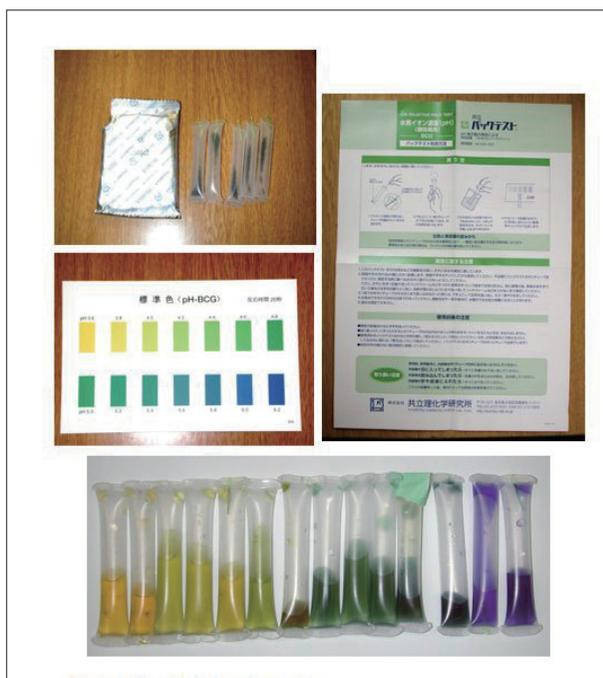
図1 酸性雨測定セットの写真
