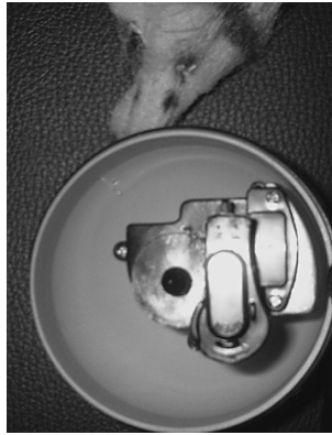
図 3 ジャレっこモーラーのボール部分の内部構造 ボール部分の内部に単 3 電池駆動のモーターがあり，そこに錘が付いていて，回転中，運動方向が変わる様になっている。
