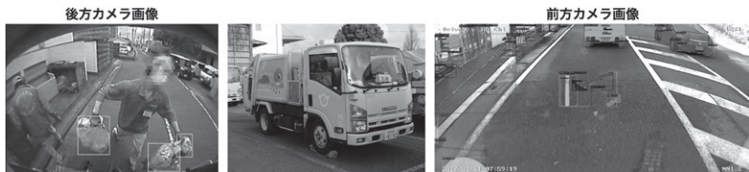
図2 パッカー車と前後方カメラ画像
