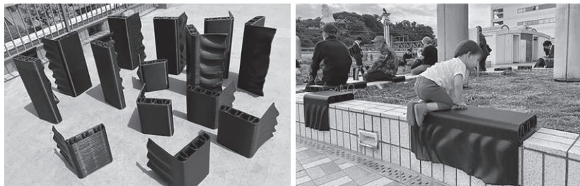
(図6) 使用済みコーヒーかす粉末を溶融したプラスチックを用いたベンチ
