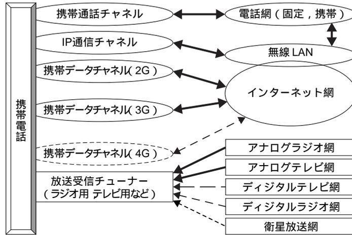
凡例：矢印は情報の流れ。実線は既にサービス提供中のもの。破線は今後の接続形態。□は放送，○は通信。
