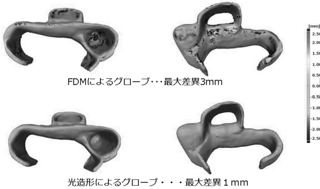
写真 9 選手自作グローブの 3D スキャンデータから異なる方式で製作した車イスマラソン用グローブ。濃淡の違いは元グローブとの差を示している
