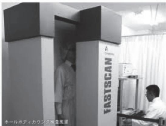
図 1 キャンベラ社製ホールボディカウンター (写真: ひらた中央病院)
